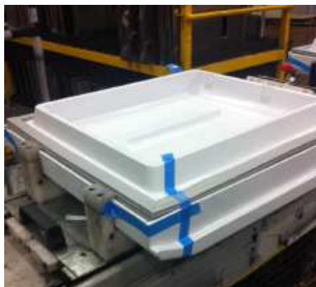
Figura 2 – Porta de refrigerador com fitas para garantir a junção do jogo pré injeção de PU.
