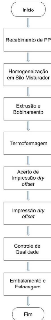
Figura 2 - Fluxograma do processo de fabricação de copos plásticos.
