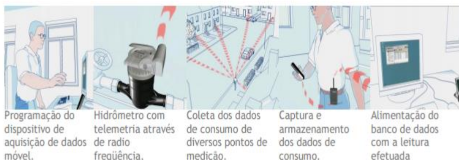
Figura 8. Aplicação de telemedição com leitura via radiofrequência
