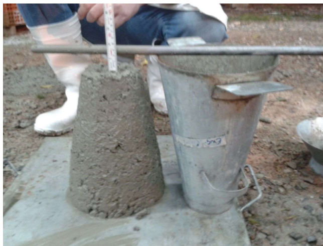
Figura 2 – Verificação da consistência do concreto
