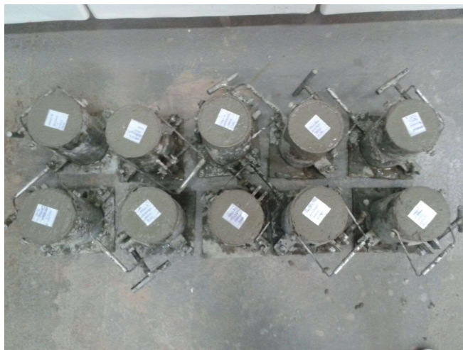
Figura 3 – Moldagem de dois corpos de prova para cada traço de concreto
