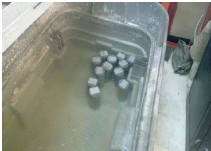
Figura 4 – Cura úmida dos corpos de prova de concreto
