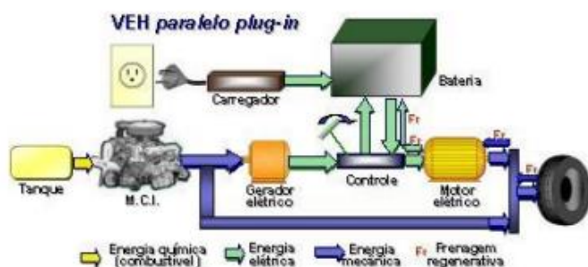
Figura 3 - Diagrama de funcionamento - Veículo Elétrico Híbrido Plug-in: (a) Série; (b) Paralelo
