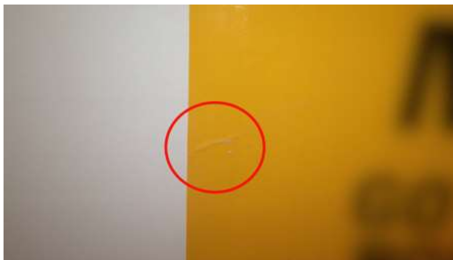
Figura 3 - Defeito denominado como bolha encontrado após a aplicação do grafismo
