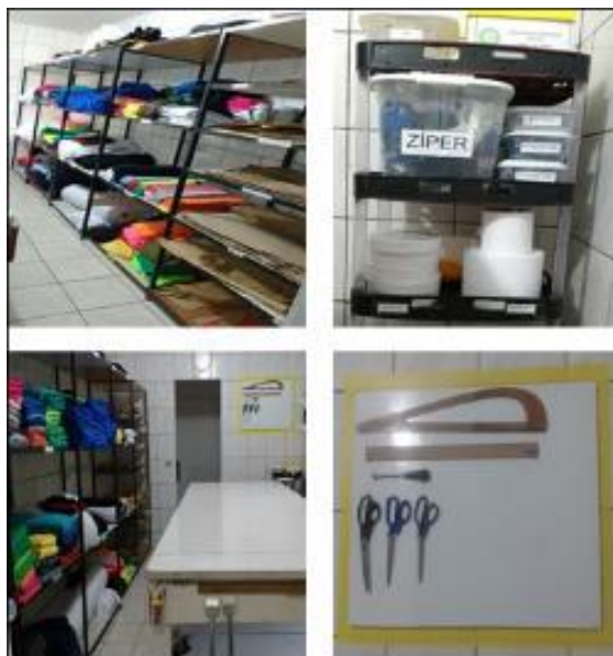
Figura 3 – Setor do corte após a aplicação do Seiton
