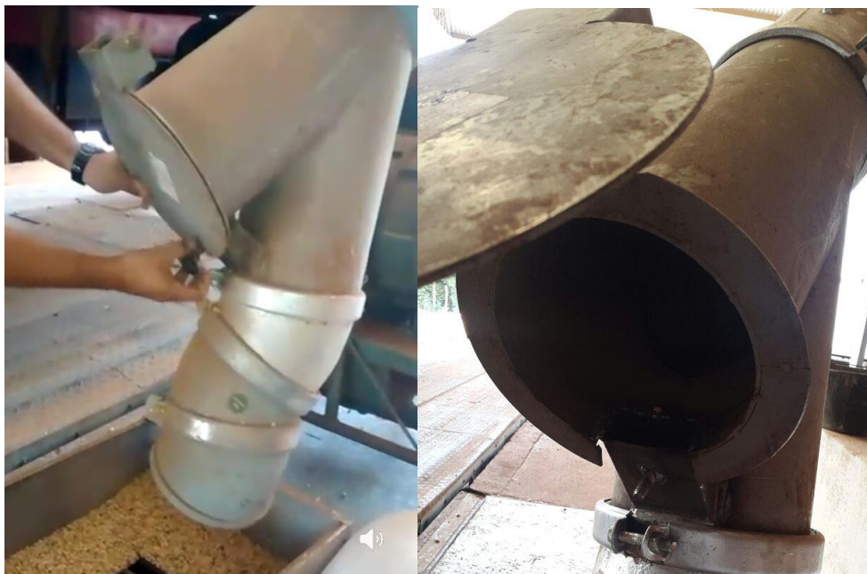
Figura 4 – Melhoria no dispositivo de amortecedores de grãos – autolimpante
