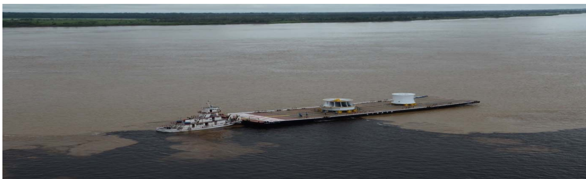
Figura 8 - Transporte de rotor de turbina por meio de balsa reforçada
