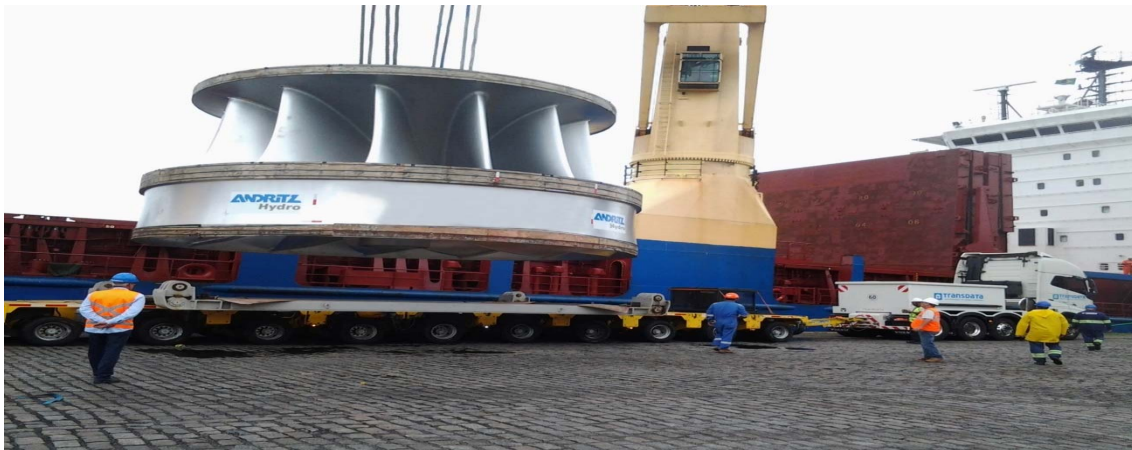
Figura 7 – Içamento de rotor de turbina por navio no Porto de Santos
