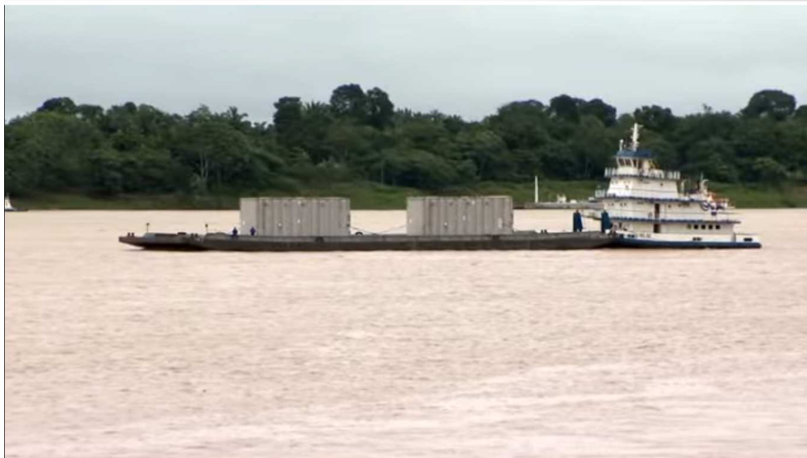
Figura 2 – Transportando o Transformador HVDC.
