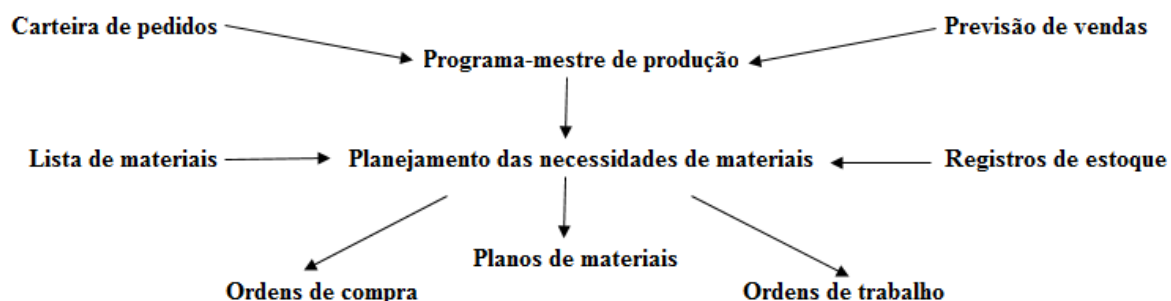
Fonte: Slack et al. (2009, p. 426) Figura 1 - Entradas e saídas do MRP
