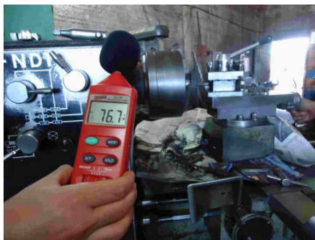
Figura 2 – Medição de ruído no torno mecânico (usinagem)
