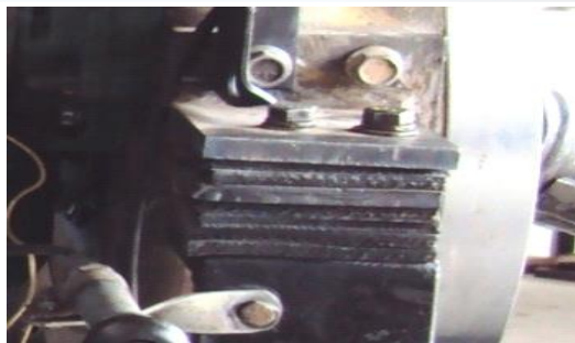
Figura 2 – Coxim rígido utilizado atualmente no teste em estudo
