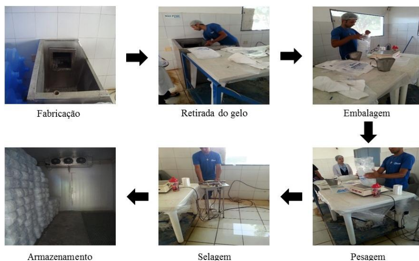
FIGURA 2 – Fases do processo produtivo de gelo. Fonte: Elaboração dos autores (2016).
