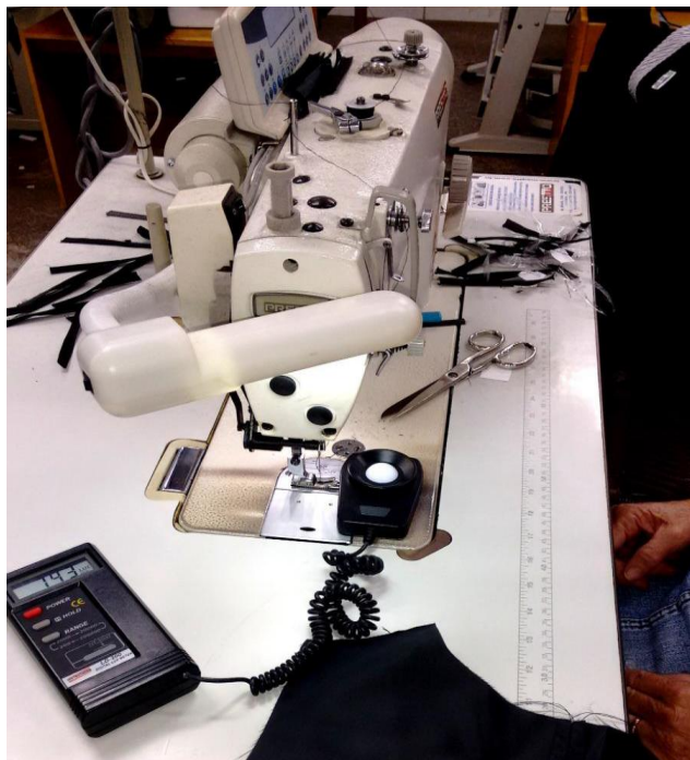
Figura 6: Medição de iluminância no posto de trabalho. Fonte: Próprio autores (2016)
