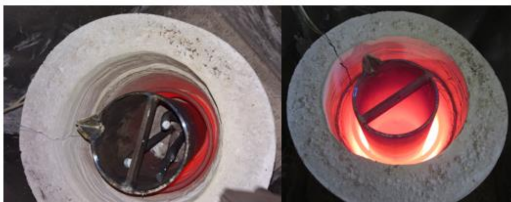
Figura 9. Etapa de fundição de Alumínio
