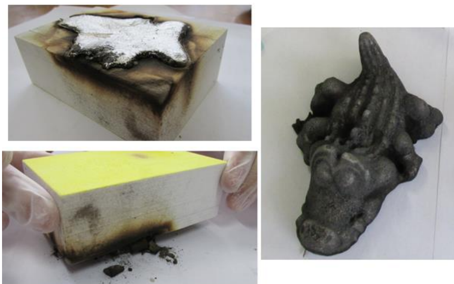
Figura 11. Etapa de arrefecimento e desmoldagem, resultando na peça fundida
