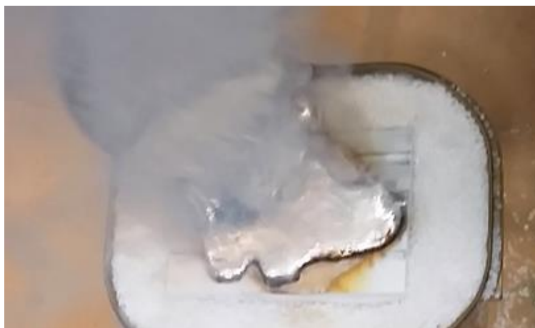
Figura 12. Ferramenta em contato com o alumínio vazado no molde
