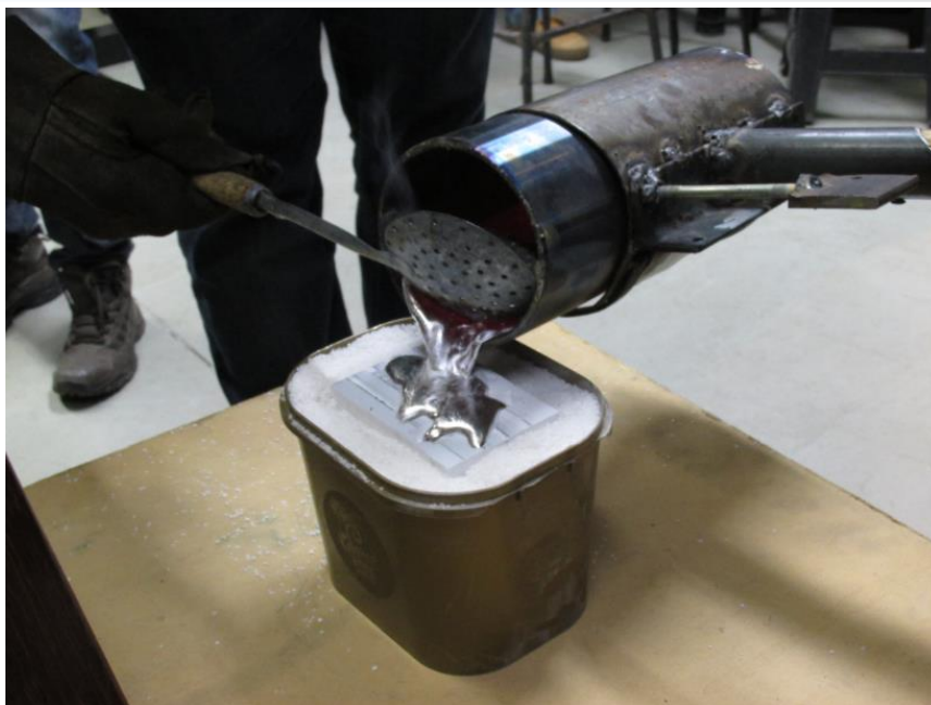
Figura 10. Alumínio fundido sendo vazado no molde de gesso
