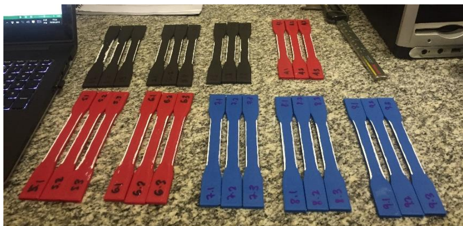
Figura 3 - Corpos de provas impressos
