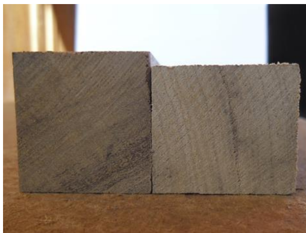
Figura 1 - Peças aplainadas com variações nas medidas
