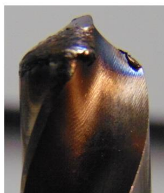
Após 6 furos (falha)
