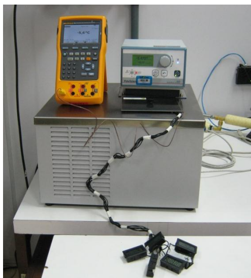
Figura 4 – Ensaio de aferição nos NTC 10k utilizando polycience modelo 9002A11B e calibrador de processo de documentação 753 e 754
