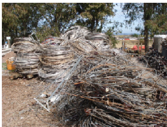
Figura 3 - Resíduos gerados na execução de obras. Cabos de aço, alumínio e cobre
