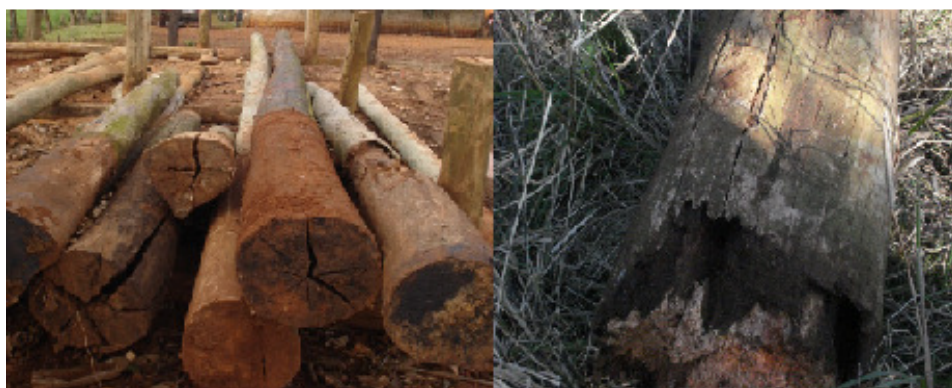
Figura 2 - Resíduos: Postes de Madeira contaminados. Resíduos, parte inferior danificada do poste
