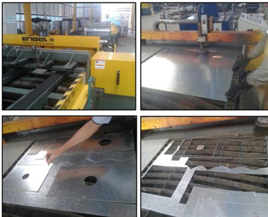
Figura 3 – Corte mecânico da chapa de aço
