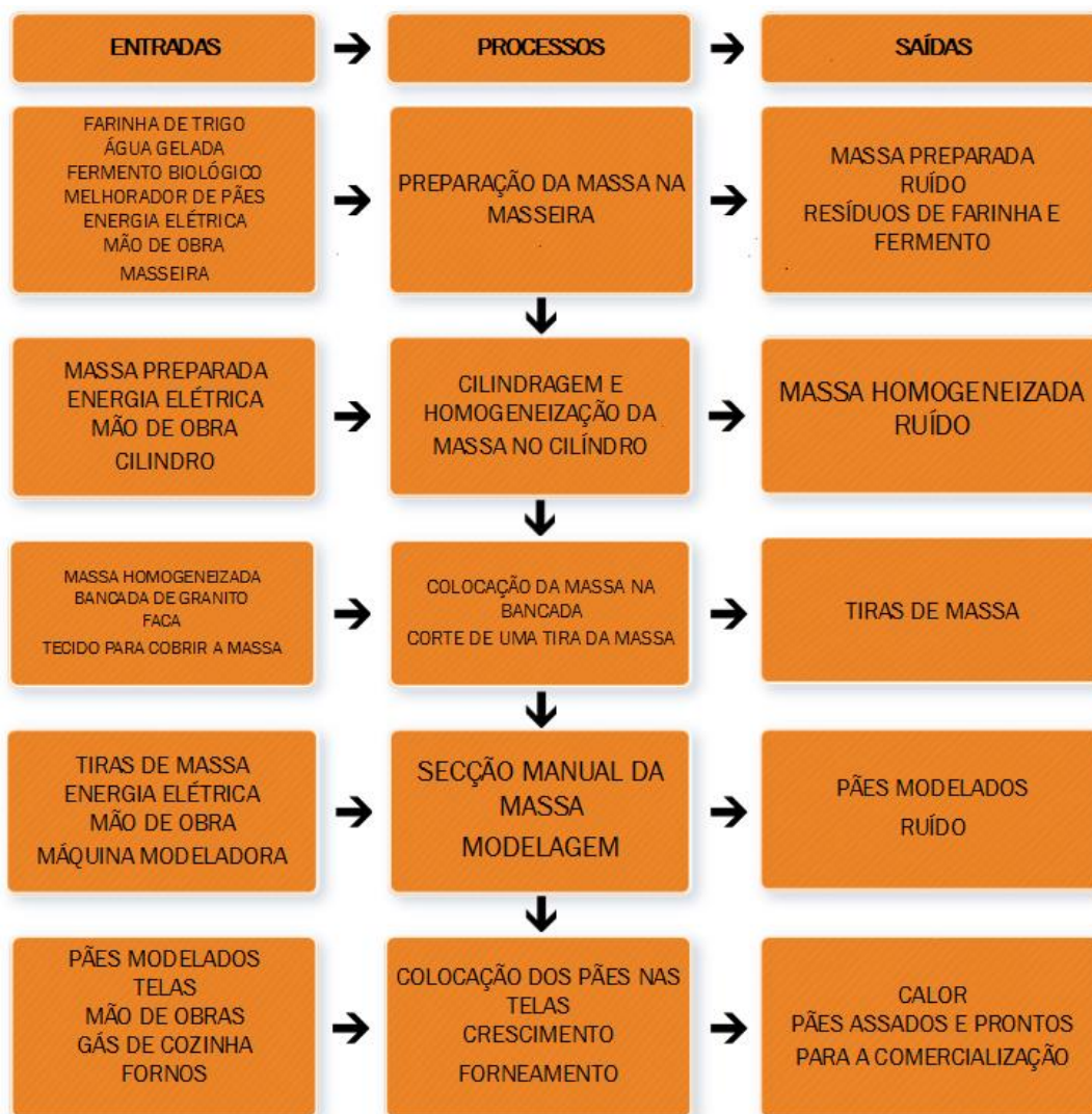
Figura 3 - Fluxograma do processo de produção atual do pão francês
