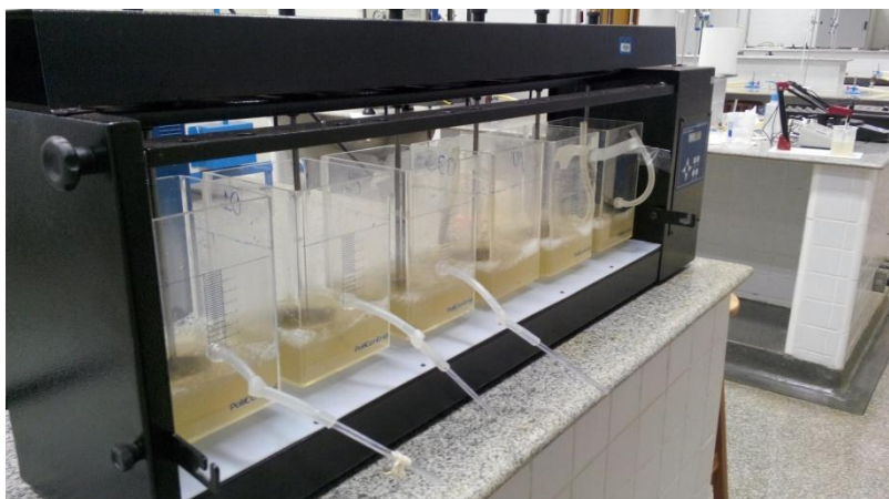
Figura 1 - Procedimento de jar test com coagulante orgânico em esgoto.
