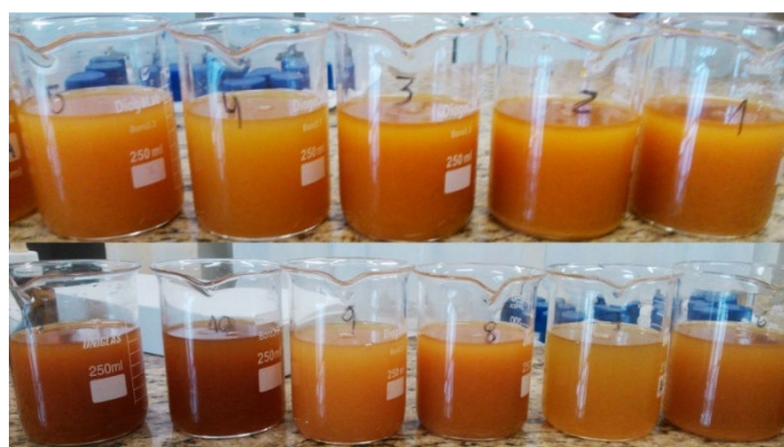
Figura 1 – Ensaio de tratamento de efluente de cervejaria por processo Fenton
