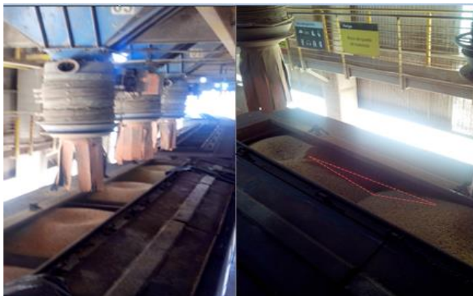
Figura 2: Carregamento pelas trompas telescópicas (Fonte: Autoria própria).
