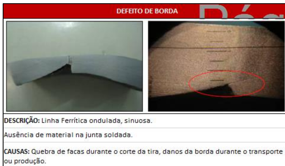
Figura 10 – Padrão visual de defeitos de soldagem – Defeito de borda Fonte: Tuper (2015b)
