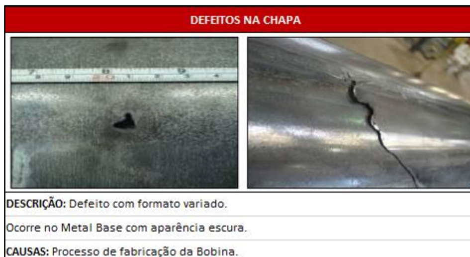
Figura 8 – Padrão visual de defeitos de soldagem – Defeitos na chapa Fonte: Tuper (2015b)
