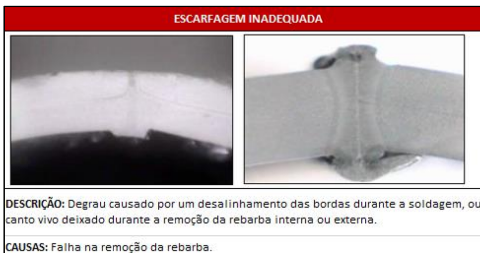
Figura 9 – Padrão visual de defeitos de soldagem – Escarfagem inadequada Fonte: Tuper (2015b)
