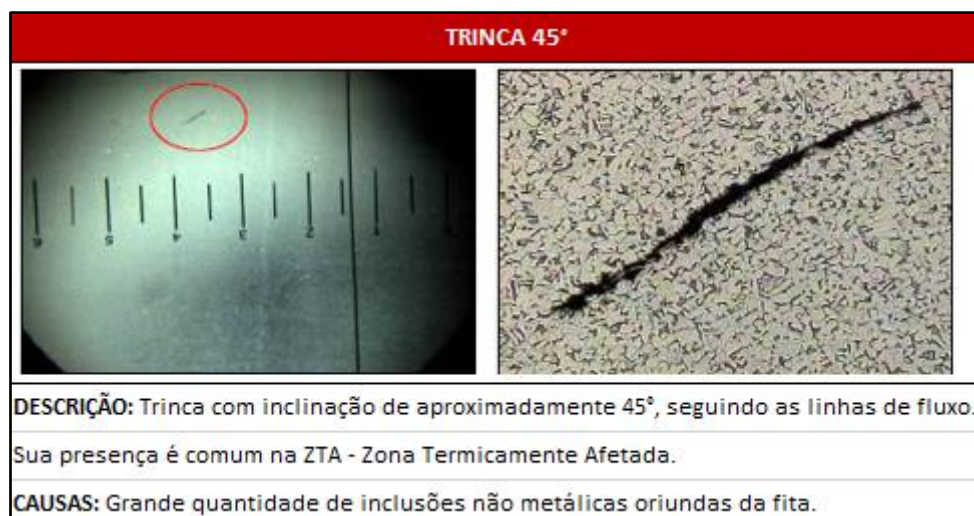
Figura 11 – Padrão visual para defeitos de soldagem – Trinca 45° Fonte: Tuper (2015b)
