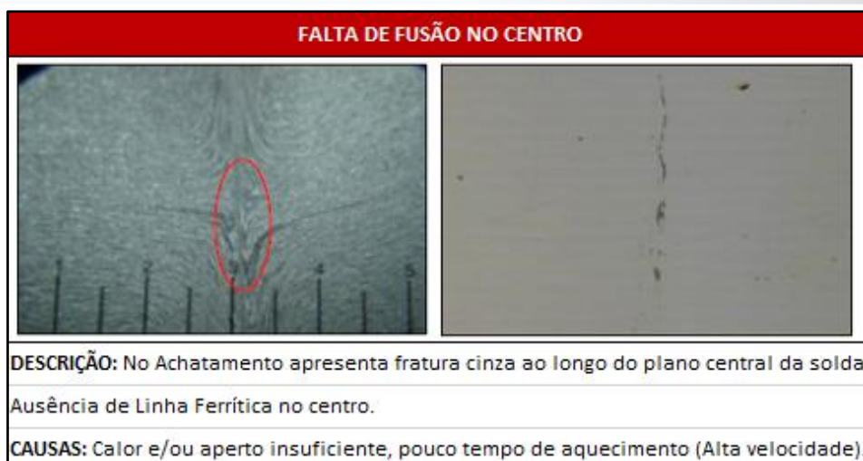
Figura 12 – Padrão visual para defeitos de soldagem – Falta de fusão no centro Fonte: Tuper (2015b)
