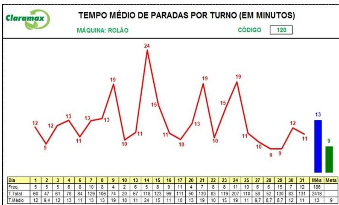
Figura 6 - Tempo diário para troca de bobina, tempo médio mensal e meta de parada por troca de bobina no mês de julho de 2015.
