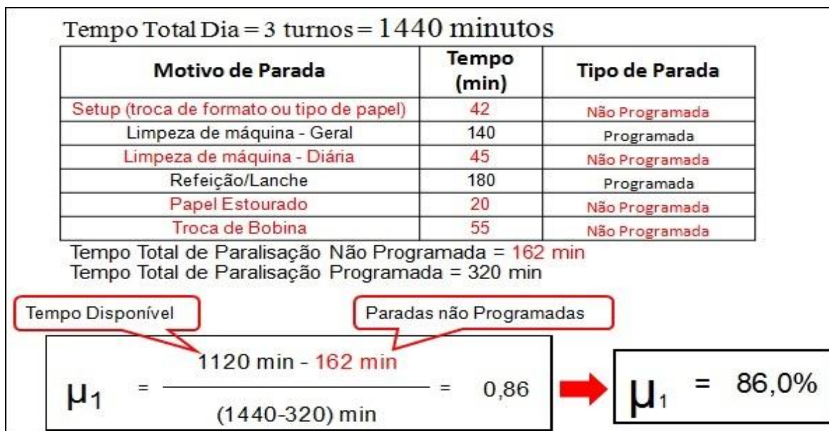
Figura 4 - Quadro exemplo de cálculo do \mu_1 a partir das paradas da máquina Rolão.
