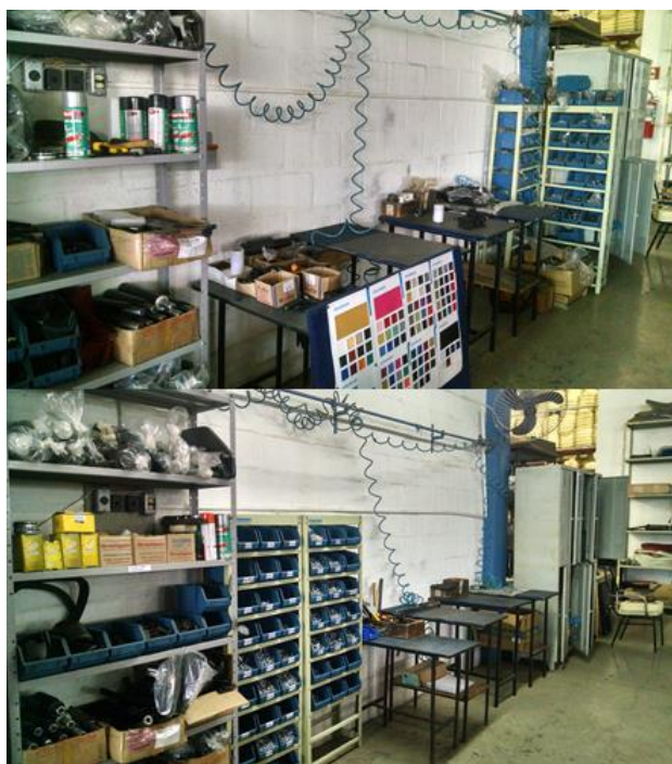
Figura 3 – Setor de reforma antes e após a utilização das ferramentas Lean Fonte: Empresa X (2015)
