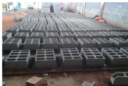
Figura 2 – Blocos de concreto com dimensões 0,14x0,19x0,39
