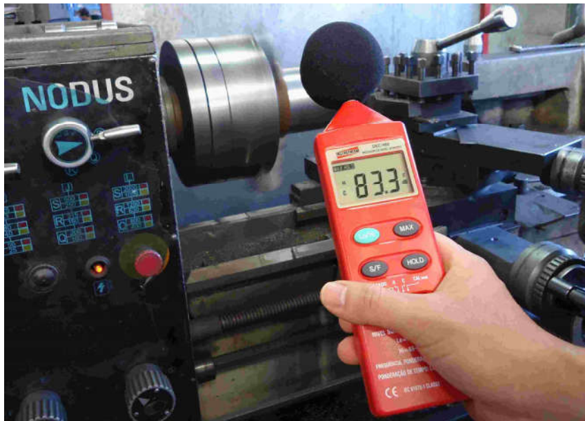
Figura 2 – Medição de ruído na utilização do torno mecânico
