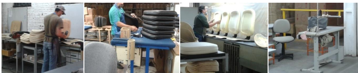
Figura 4 – (a) Mesa de junção de assento e encosto; (b) Mesa de prega de almofadas; (c) Mesa das costureiras; (d) Mesa de prega de tecidos e acabamento lateral
