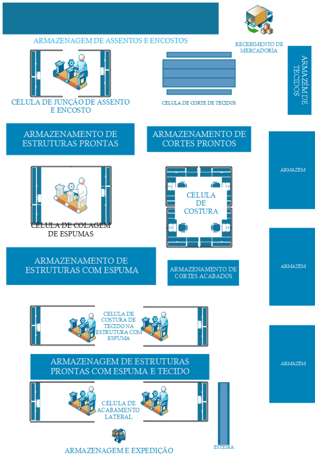
Figura 6 – Layout em células proposto para o setor de estofamento
