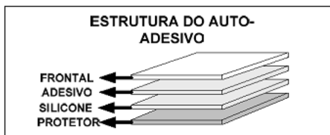
Figura 1- Estrutura do Auto-Adesivo Fonte: GEORGES, (2010)
