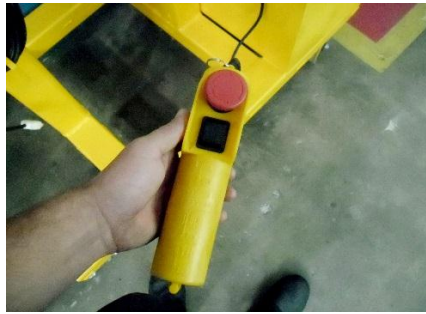
Figura 7- Equipamento proposto. Acionamento elétrico com botão de segurança
