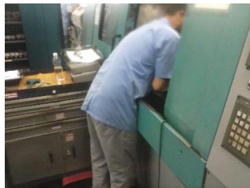
Figura 4- Troca de ferramental sem utilização de equipamento
