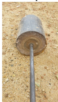
Figura 3 - Detalhe do coxim de nylon na parte inferior do martelo (Autores, 2015)
