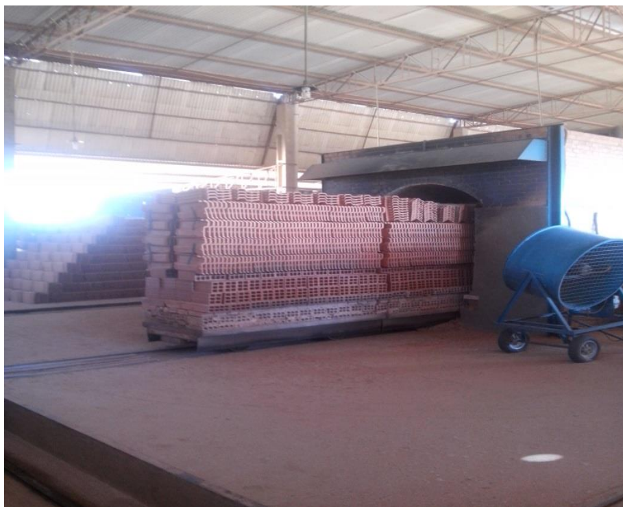
Figura 1: Saída dos Produtos do Forno Túnel Contínuo. Fonte: Autor (2015)
