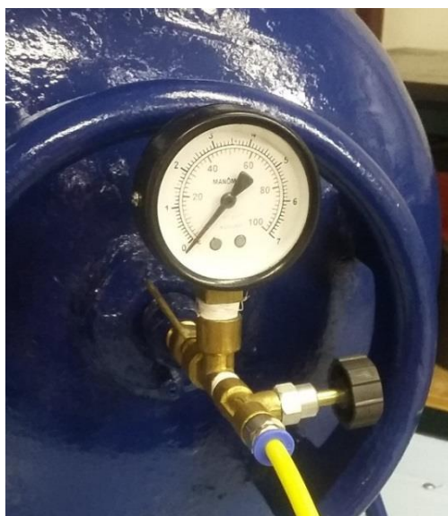
Figura 5 – Sistema de pressurização
