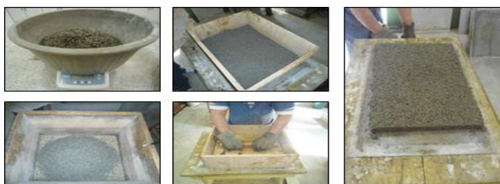
Figura 1 – pesagem e conformação e pré-prensagem dos painéis
