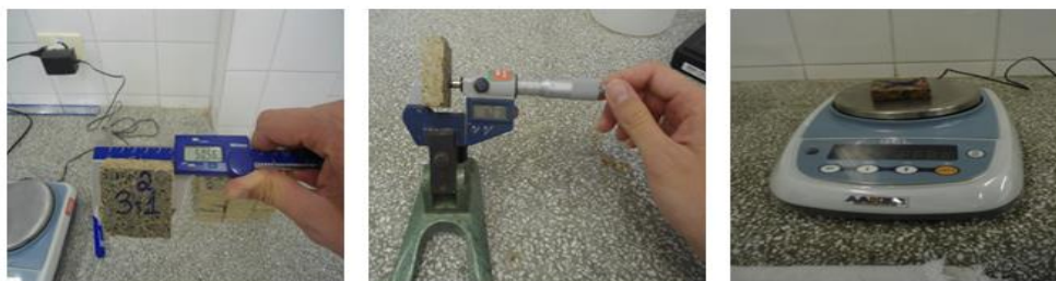
Figura 4 – Etapas para determinação da massa específica do painel.
