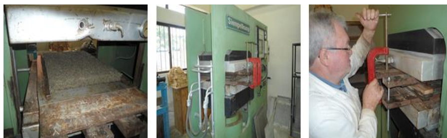
Figura 2 – prensagem e grampeamento dos painéis.
