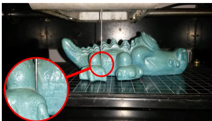
Figura 2 – Processo de digitalização Roland Modela MDX-20
