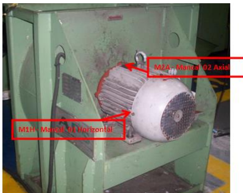
Figura 8 – Pontos de medição dos níveis de vibrações no Puxador de Aparas
