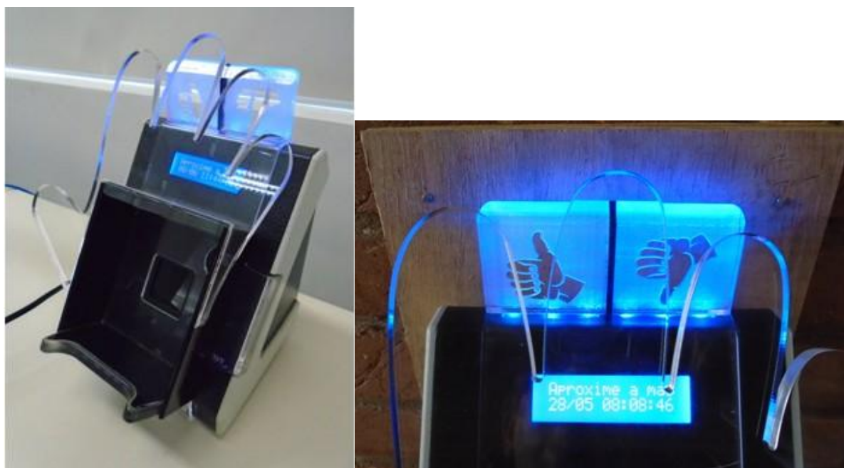
Figura 5 - Quarta geração do leitor de identificação biométrica com nova guia para a colocação da mão e melhorias visuais de identificação
