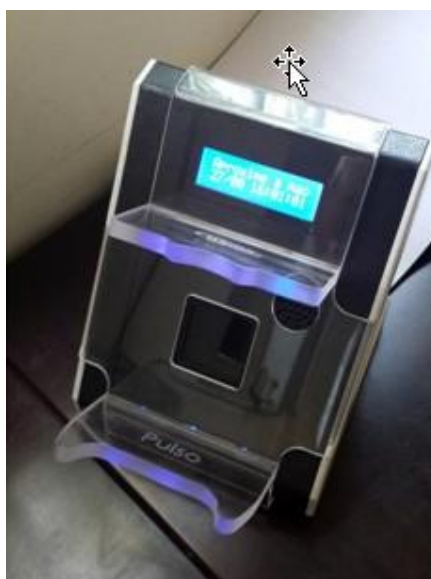
Figura 3 - Segunda geração do leitor de identificação biométrica com sistema operacional Microsoft Windows Embedded e Mini PC Intel NUC
