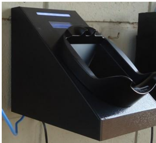
Figura 4 - Terceira geração do leitor de identificação biométrica com sistema operacional Linux, bloqueador de luz e placa ARM Cortex A9 de 1.7GHz Quad-core com 2GB LPDDR2
