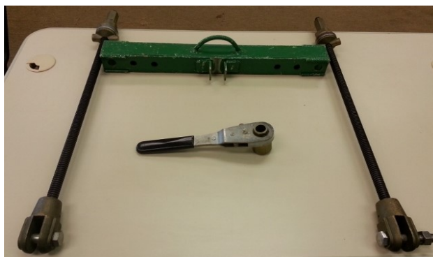
Figura 2 – Ferramenta para manutenção da ferragem dos cabos para-raios Fonte: Autor (2015)
