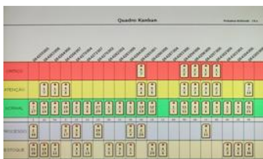
Figura 4 – Kanban por meio de indicações luminosas
