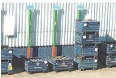
Figura 2 – Kanban por meio de caixas
