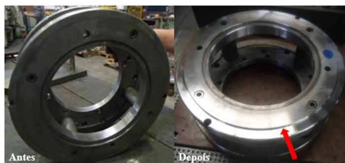
Figura 4: Modificação no castelo para eliminar o ajuste (centrar)
