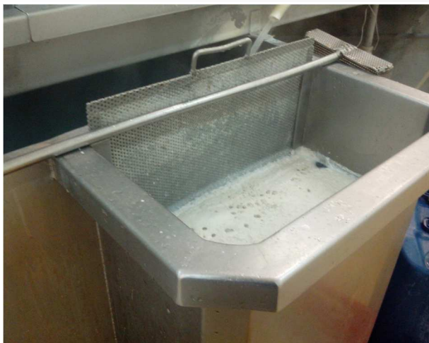
Figura 8 – Nova grade lateral com chapa em aço inox com furos de 5 mm Fonte: Autoria própria
