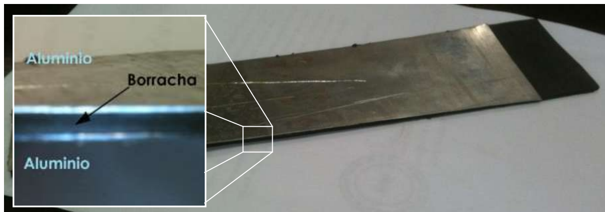
Figura 3. Compósito Laminado tipo Sanduiche Alumínio-Borracha (BoRAL)
