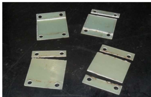
Figura 3 – Molas planas de vibração com ruptura precoce Fonte: Autoria própria
