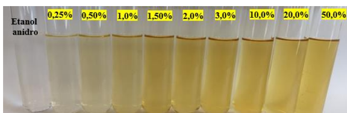
Figura 2 - Etanol anidro com adição de óleo fúsel contendo 14% de água
