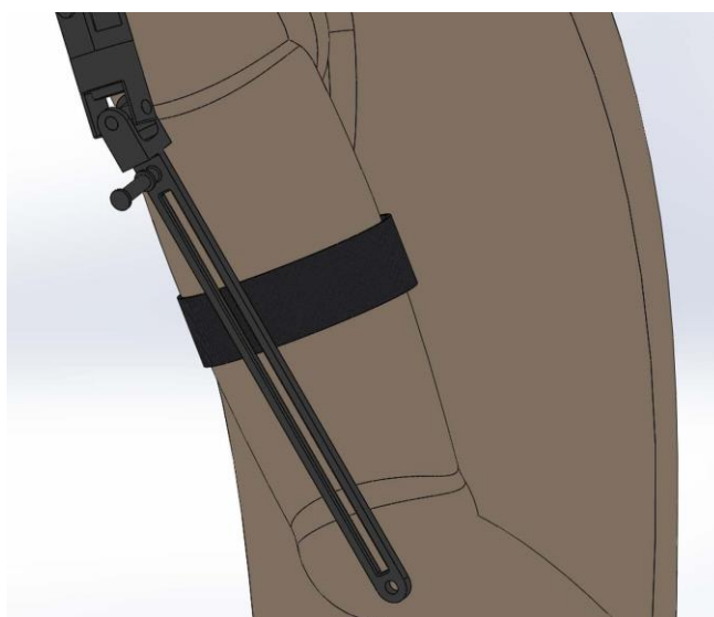
Figura 7 – Antebraço com suporte preparado para receber pistão linear e fivela de amarração.
