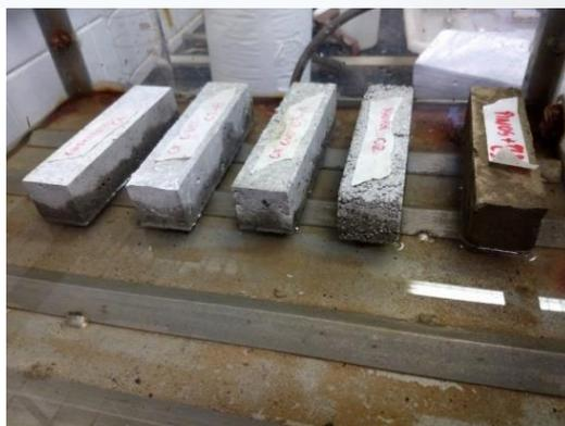
Figura 04 – Corpos de prova posicionados em recipiente com 5 mm de água
