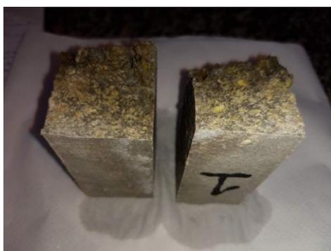
Figura 05 – Corpo de prova com compósito de caixa de ovo após teste de flexão
